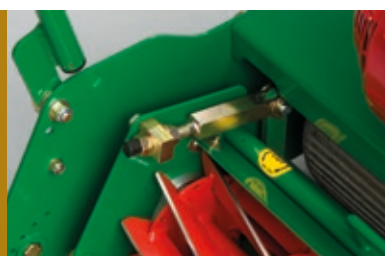
Jednoduché a spoľahlivé nastavenie vretena voči spodnému nožu
