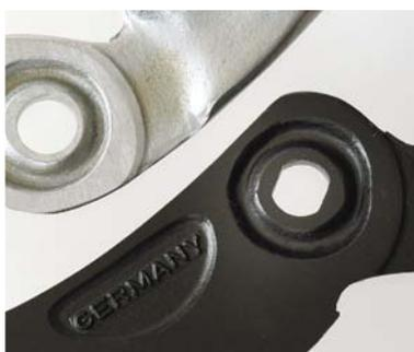
Die Innenseiten von Klinge und Haken haben einen eingeschmiedeten Rundgang für eine leichte Verteilung von Öl oder Reinigungsflüssigkeit innerhalb des Schneidkopfes. Ohne Demontage der Schere können diese Stoffe durch eine eingeschmiedete Rille einfach von außen zugeführt werden.
